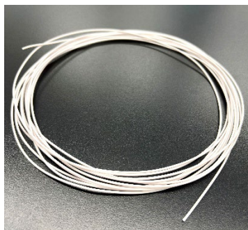
電線被覆材を想定して「ペルプレン®」NCタイプを用いて押出成形したサンプル
