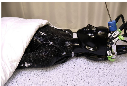
発汗マネキン「TOM ® 」Ⅲによって、「ブレスエアー ® 」製のマットレスを使用した際の背中部分の「むれ感」を測定できる
