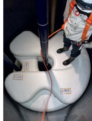
「反応缶用足場ハイボード」を用いた際の缶内の作業イメージ
