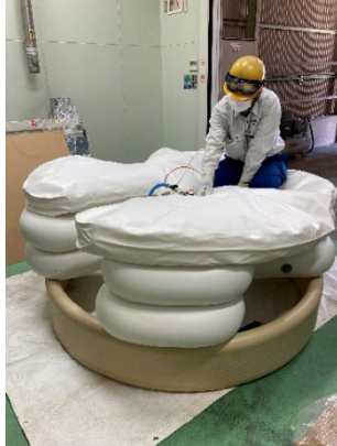
扁平ハイボードに空気を充填 ※実際は缶内で充填する
