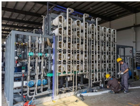
GEMに採用された中空糸型膜モジュール「ホロセップ®BC膜」を搭載した濃縮装置
