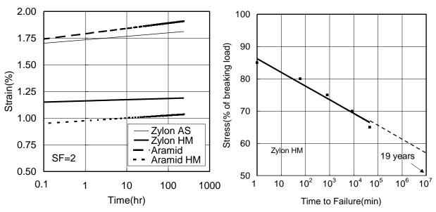
クリープパラメータ(上左図の直線の傾き)をパラアラミド繊維と比較しました。ザイロン®はパラアラミド繊維の半分以下のクリープ伸びしか生じないことがわかります。
