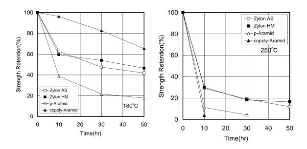
高湿度雰囲気下では、100℃以下の温度でも強度低下が起こります。高温多湿の場所は避けて保管して下さい。
