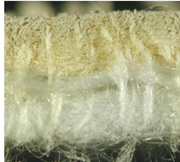
ポリエステルに异形ポリイミドをブレンドろ布 （フェルト断面）
